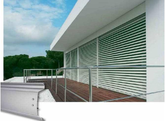
La protezione del prodotto impedisce che la tenda sia danneggiata in caso di urto contro ostacoli. Lamelle in alluminio con bordatura alle loro estremità, con guarnizione silenziatrice a labbra applicata a pressione. Verniciatura a fuoco in 100 colori standard. Binari di guida laterali in alluminio estruso, anodizzazione incolore, con elementi di scorrimento e silenziatori in plastica sulle braccia di posizionamento.
